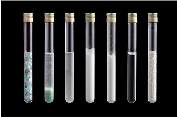
Il s'agit de la première approche biologique permettant de recycler à l'infini les plastiques PET. L'enzyme d'origine a été découverte dans la nature mais sous cette forme, sa stabilité thermique et son activité de dépolymérisation du PET n'étaient pas suffisantes pour un cycle industriel. Les deux propriétés ont été fortement améliorées par CARBIOS et ses
