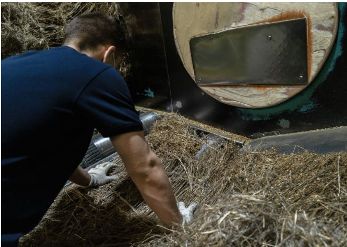
Déroutage des balles de paille de lin avant l'entrée dans la teilleuse, à l'usine Decock, à Hondschoote, dans le Nord, le 10 mai 2021. AIMÉE THIRION POUR « LE MONDE »
